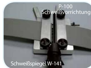
*Gewebeverstärkte Bänder sollten schräg verschweißt werden.*
