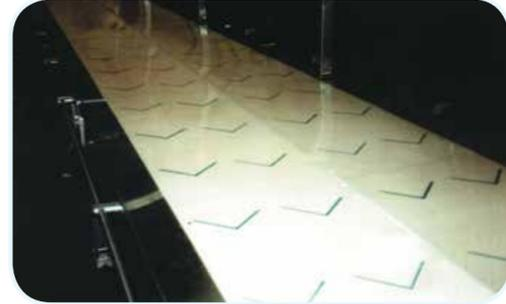
Führungslinien können direkt in das Material des Basisbandes geschweißt werden und ergeben eine glatte, homogene Oberfläche; beispielsweise mit Markierungen in Kontrastfarben oder dauerhaften Kennzeichnungen von Produktionslinien direkt in Ihrem Band.
