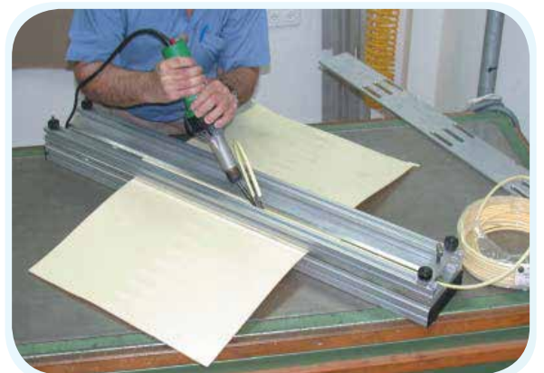
Stabschweißen von Profilen
